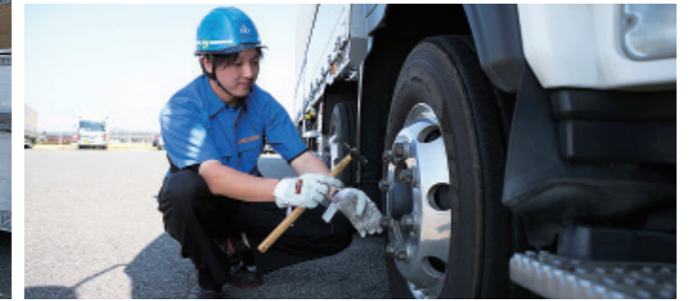
毎日の点検は欠かせません。ナットの緩みなし！
