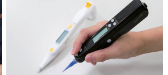
自社製品のペン型電動ビベット(左)とペン型電動ディスペンサー(右)
