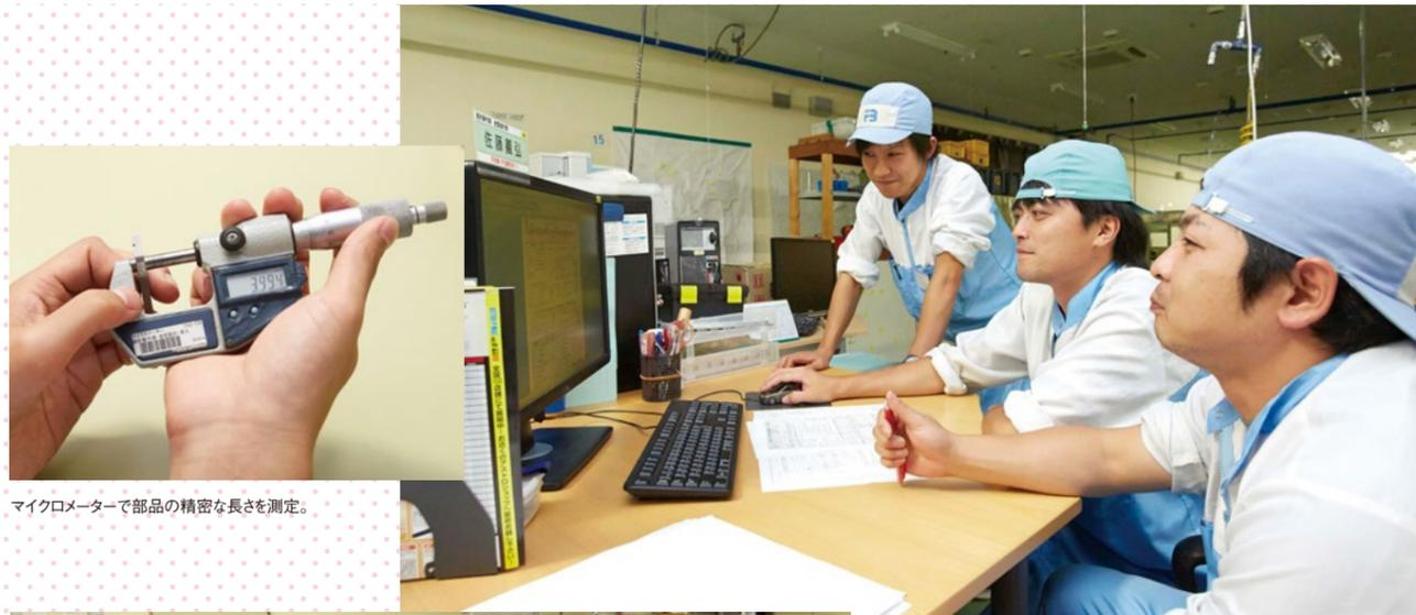
マイクロメーターで部品の精密な長さを測定。
