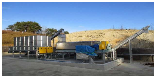
【導入した廃菌床脱水機】
