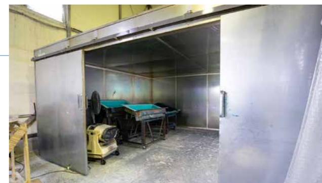
冬季でも温度を一定に保つことのできる硬化炉。年間を通して安定して硬化させることができるようになった。
