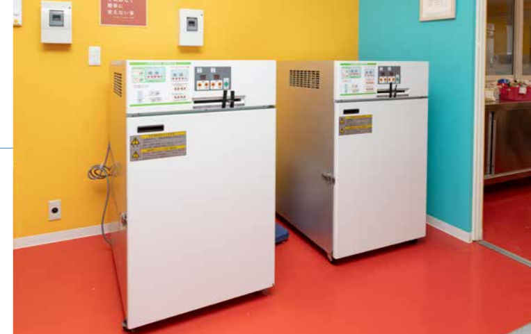
わかめ太茎をカット後、乾燥させるための電気食品乾燥機。従来の乾燥機と合わせて4台に。
