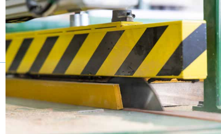
釘打ちや穴あけを終えた型枠を、下側から出てくる丸ノコで裁断する。手作業よりも飛躍的に効率が上がっており、安全性も確保された。
