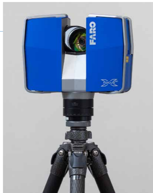
今回導入した3Dスキャナー。中央に設置されたミラーで光を反射させ、カメラの範囲内にある構造物を3Dデータとして読み取る。
