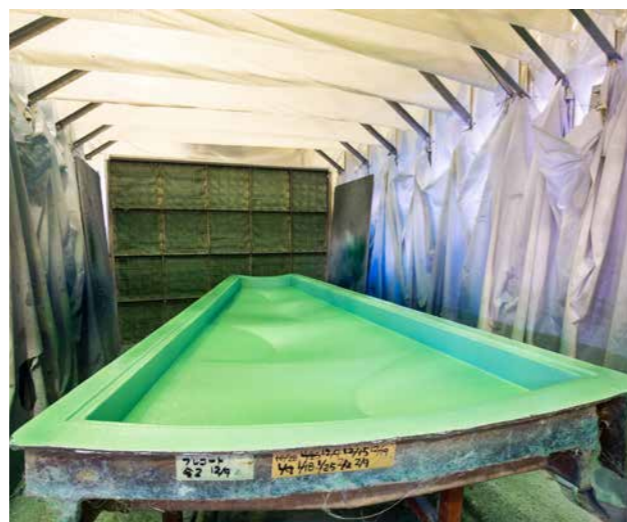
集塵・排気装置を備えたジャバラテント式塗装ブース。ここで型に特殊なゲルを吹き付ける。
