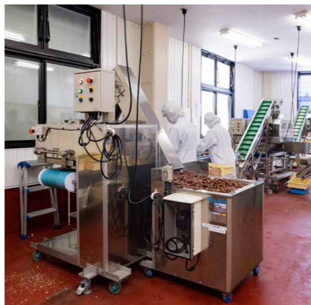
栗を二つ割りにする装置。割った栗の切り口が上向きになるように流れるので、選別がしやすい。
