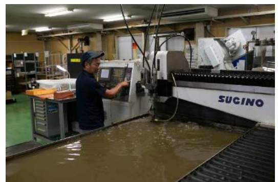
Water/Jet 切断機 〈スギノマシン CL2010NN-AB〉
