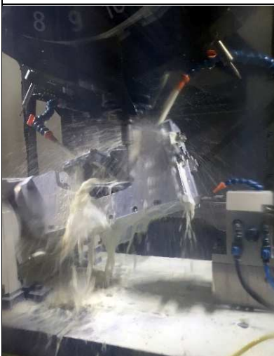
ダイカスト光学部品の5面加工を 高精度に量産加工 (H26 補正もの補助事業)
