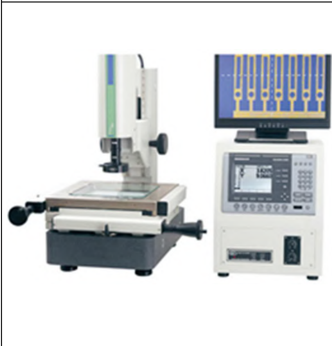
二次元画像測定器 チェンウェイ社製CW-2020N型 ●お客様の要望にあわせ、ピッチ測定、刃物角度測定もできます。
