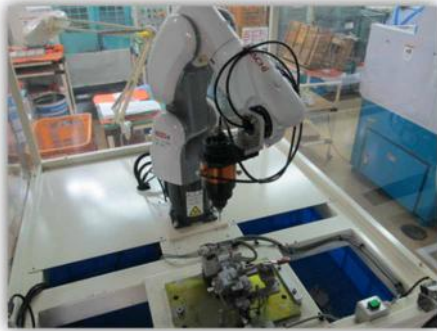
【ロボット使用による、バリ処理工程の簡略化】
