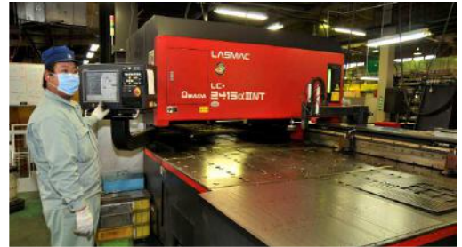
レーザー加工機 t 6.0 まで加工対応可能。
