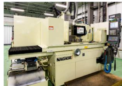
超精密成形平面研削盤 (SGC-74SL2D-Zero3)
