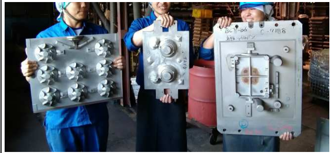
各種鋳型造型用プレート <DISA造型機、F1造型機、SMS造型機>
