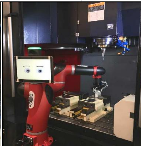
AI 協働ロボットとマシニングセンターを組合わせ 生産品目の切替に対応した自動生産 (H29 補正もの補助事業)
