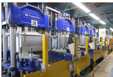
250Ton 自動真空を中心とした 45 台の成型機で試作から量産まで様々な形状に対応します。
