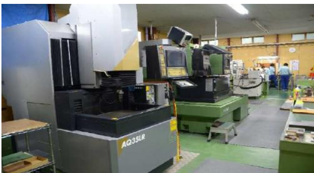
放電加工機・ワイヤー放電加工機 (油仕様 W線Φ 0.05・Φ0.07・Φ0.1mm)
