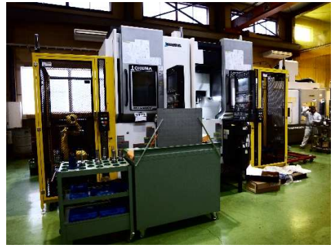
連結可能縦型5軸マシニングセンタ
