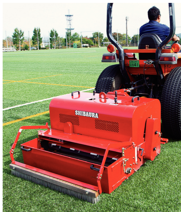
本事業により導入した「トラクター連結式新型ロングパイル人工芝管理機」。
