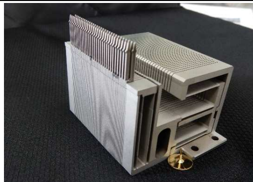
ワイヤー放電加工による一体加工品。楕円刃及び微細加工 (半導体用心臓部部品)
