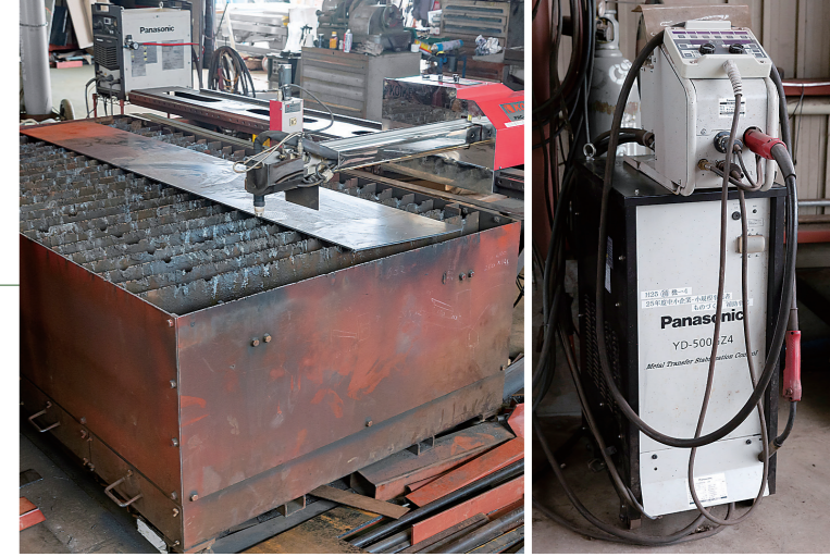
本事業により導入したエアープラズマ切断機とFD溶接機。
