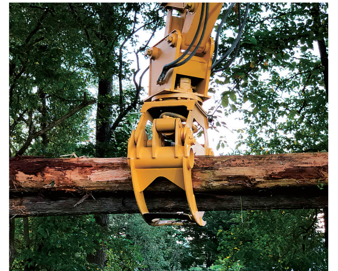
モーションセンサー内蔵林業用アタッチメントを装着した高性能林業重機。
