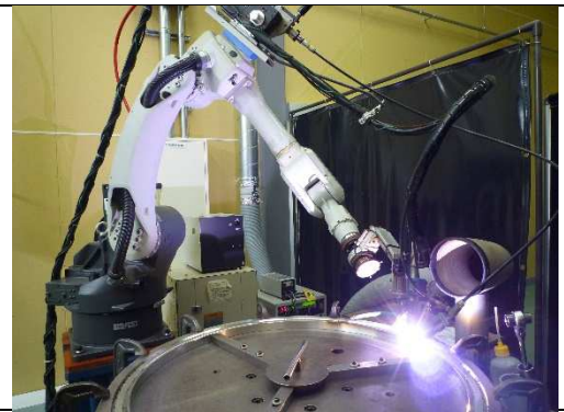
ロボット溶接による安定した品質の接合品の提供
