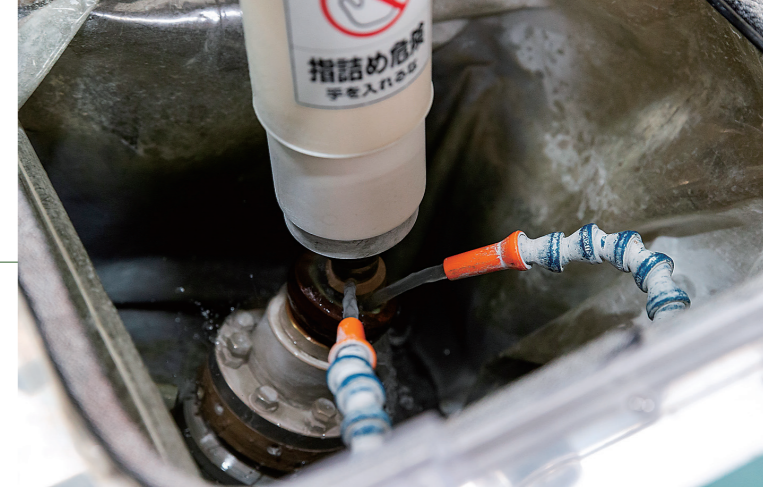
従来の研磨機ではできなかった肉厚光学特殊レンズもNC高精度球芯研磨装置により可能となった。
