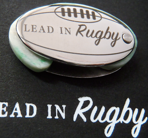
産・学・官が連携し開発した岩手発の新素材「コバリオン」にも、導入機によりレーザーマーキングに成功。【写真資料提供：関エイワ様】
