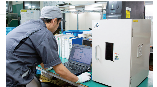
パソコンにプログラムを入力し、レーザーマーカを稼働させる。従業員3名が基本的な操作方法を習得。
