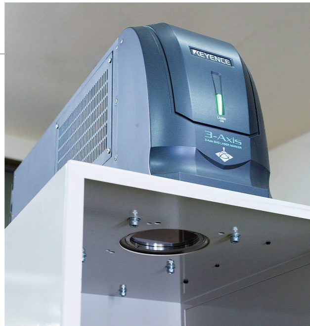
本事業により導入した、機能特化型レーザーマーカ。
