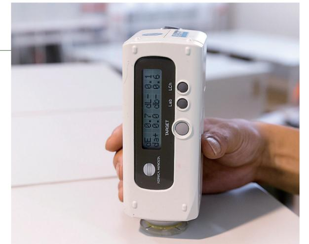
色差計で塗装の色具合を計測。塗装の艶や肌の質感などのデータを収集している。
