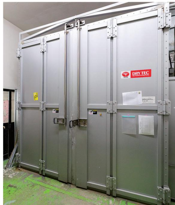
導入した排熱回収型熱風乾燥炉。
