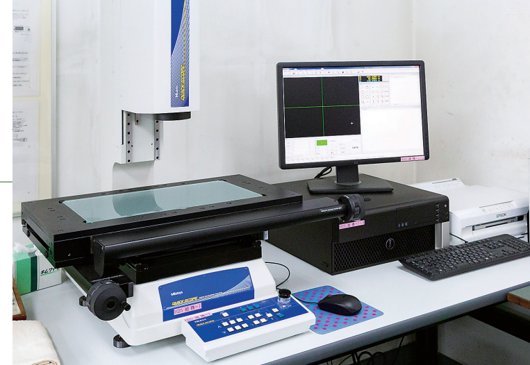
400mm×200mmのガラステーブルを備えた画像測定器。大型部品も効率よく、高精度で測定できる。
