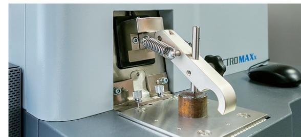
放電により発生する光で含有成分を分析する発光分光分析装置。窒素分析精度が向上し、安定した金属組織と機械的性質が得られるようになった。
