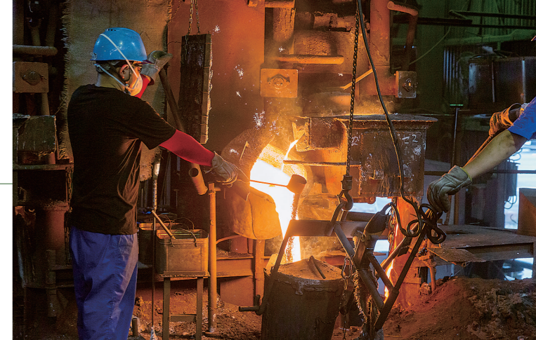
熱風装置付加キュポラによって、鑄鉄の高強度化が図られ、鑄物業界の厳しい環境の中でもキュポラ炉の存続を可能にしている。
