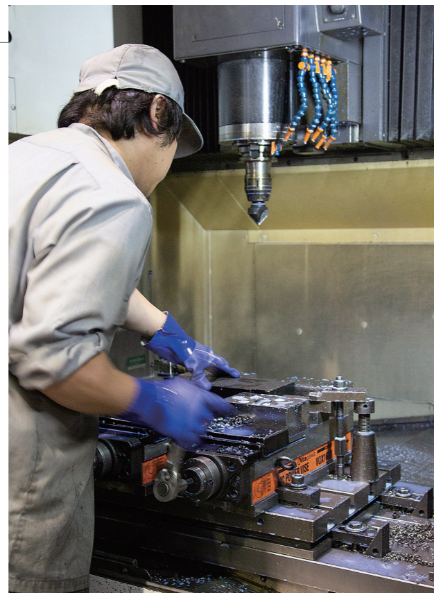
マシニングセンタに加工部品を固定、ボタン操作により自動的に加工が始まる。その間、スタッフは別作業を行うことができる。
