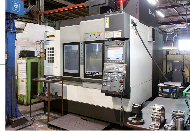
本事業により導入した立形マシニングセンタ。サーモフレンドリー機能を搭載し、熱変位を制御する。
