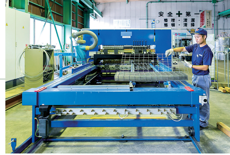
導入したドイツ・IDEAL社製の自動溶接機。溶接スピードが3～4倍に向上。
