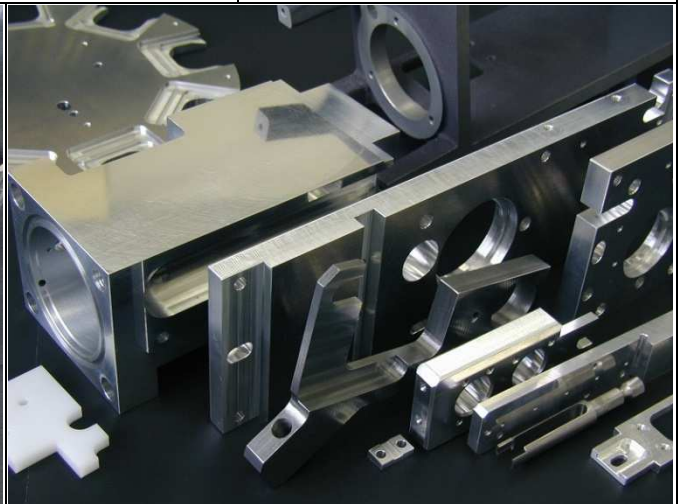
マシニングセンター加工サンプル プレート材だけでなくダイカストなど異形材の二次加工も実施
