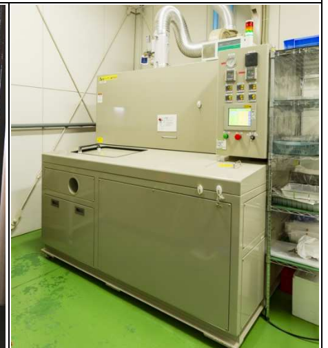
医療分析機器部品の清浄度に対応する 真空超音波洗浄工程 (H25 補正もの補助事業)
