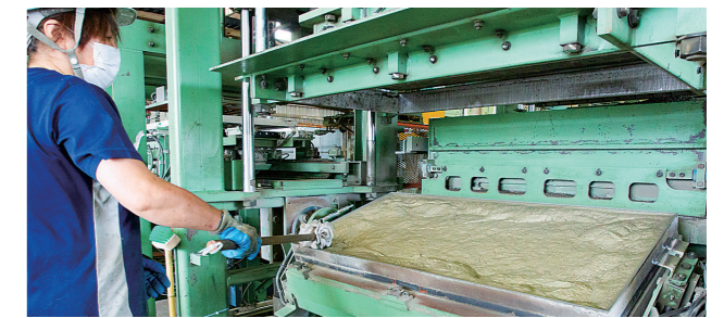
湿った砂のようなゼロスランプコンクリートは、上から強い振動と圧力をかけることで即座に成形・硬化させることが可能。
