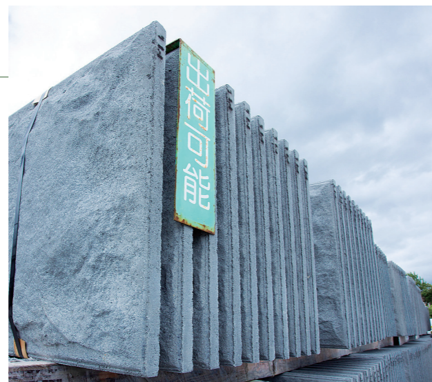
新設備で製造した残存化粧型枠。残存型枠工法では、この化粧型枠をそのまま型枠として使用する。
