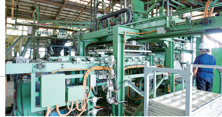
本補助事業により導入した残存化粧型枠即時脱型製造機。底板と補強部材のセット、コンクリートの供給、成形、脱型までをオートメーションで行う。
