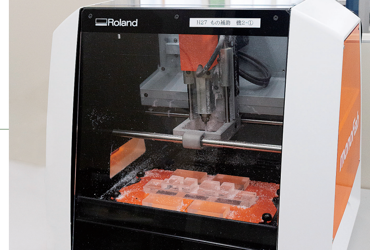
サポート部を削り取るための3D切削加工機も併せて導入した。
