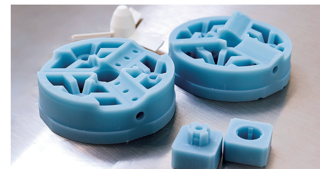
3Dプリンターで出力した樹脂製の試作金型。低コストで早い製作が可能なので様々な形状にトライしやすく、顧客のメリットも大きい。
