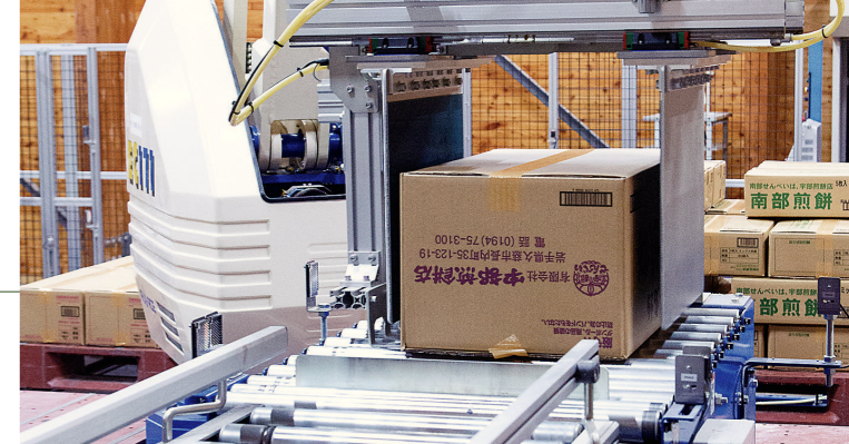
アキュムコンベアで統合された製品は、バーコードを読み取り製品ごとに仕分け。データは在庫管理システムに転送され記録される。
