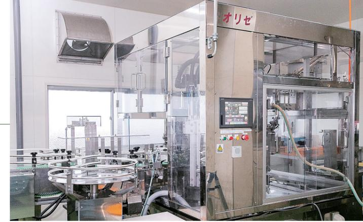
新たに導入した充填システム。ボトルの供給からキャップ取り付けまで自動で行う。
