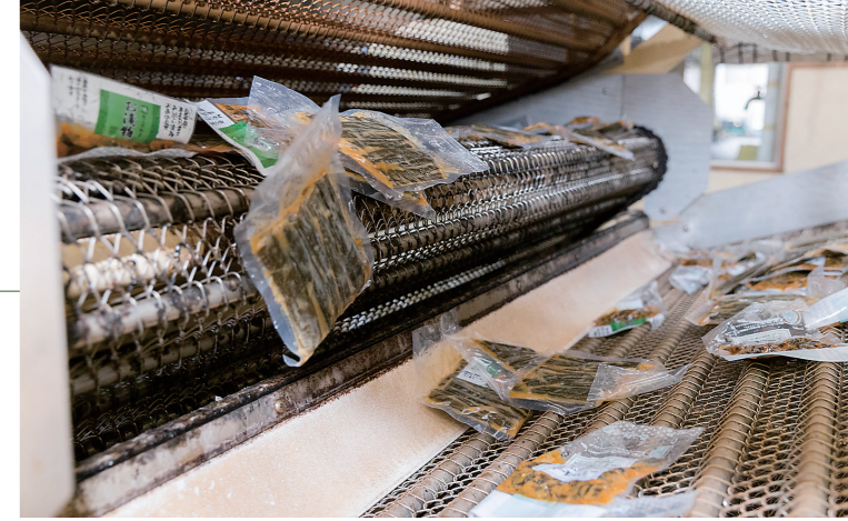
自動殺菌機で真空パックされた製品の殺菌、冷却、乾燥を行う。
