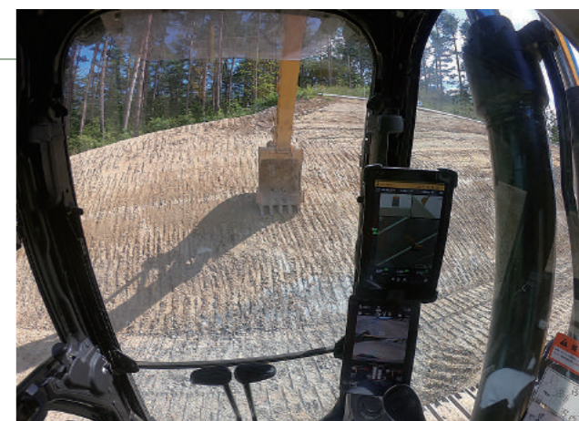
油圧ショベルの操縦席の様子。正面右手に備え付けられたモニターに、パソコンからの情報が送信される。
