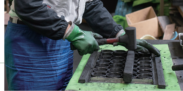
人手による締固めや型抜き作業は、時間と手間を要する。
