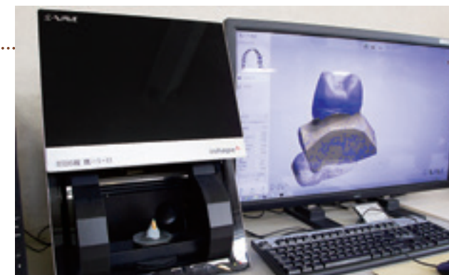
teethでは、歯科医院から提供される歯型とそれをもとに歯科技工士が製造するワックスアップの両方をスキャン、データ化し精度の高い製品を提供している。
