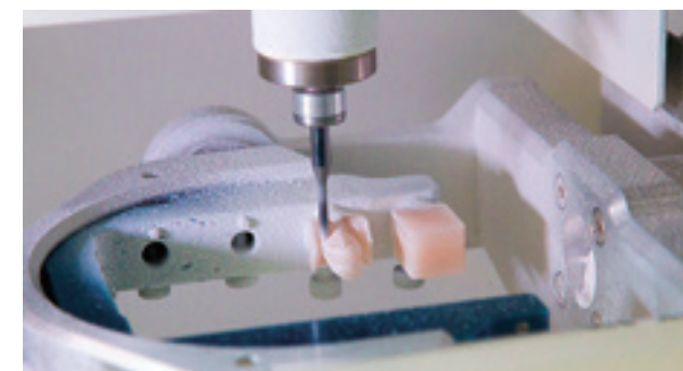
3次元スキャンした歯冠形状データをもとに、歯冠補綴物を材料ブロックから自動で削り出すミリングマシン。
