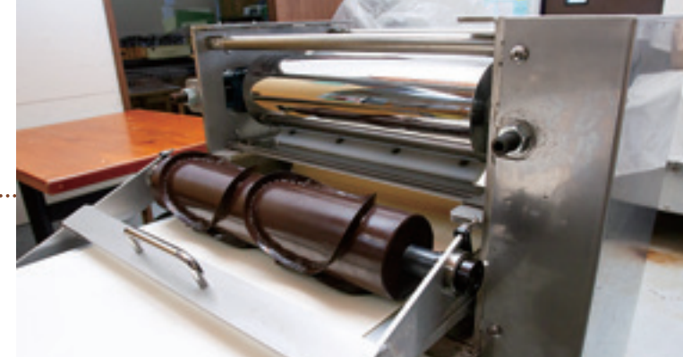
オーダーメイドで完成した「山田せんべい専用型抜き機」。ローラーで伸ばされた生地がベルトコンベアに乗り、丸型が回転してくり抜かれる。
