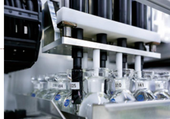
自動で溶存酸素量を測定。BOD測定を同一フラン瓶で行うことができ、フラン瓶洗浄作業も半分になった。
