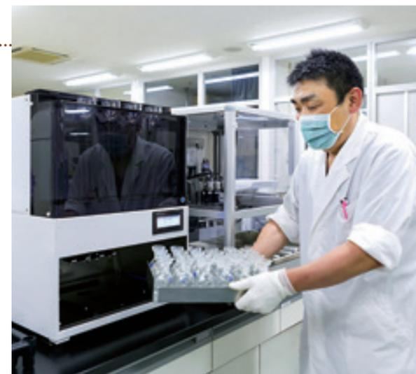
フラン瓶がセットされたカセットを順次交換することで、最大328の試料を測定。
