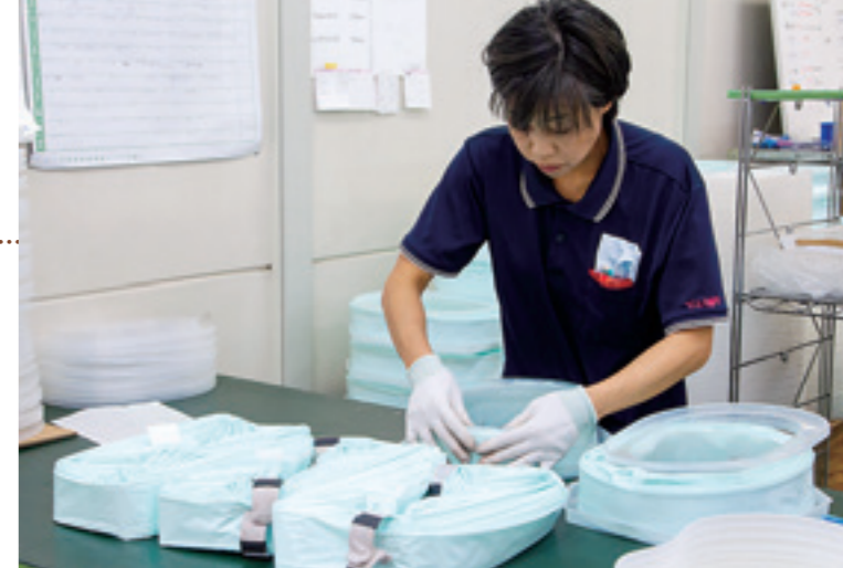
折り込み、カット工程を終えたフィルムは人手によりカセットにはめられ完成品となる。
