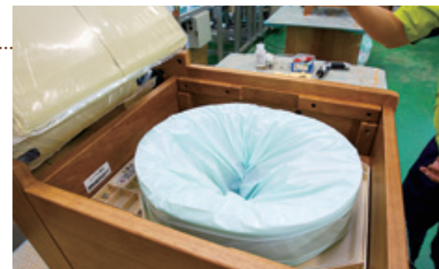
本体に装着されたフィルムカセット。排泄が終わると熱でフィルムが圧着され、密封された袋状になる。
