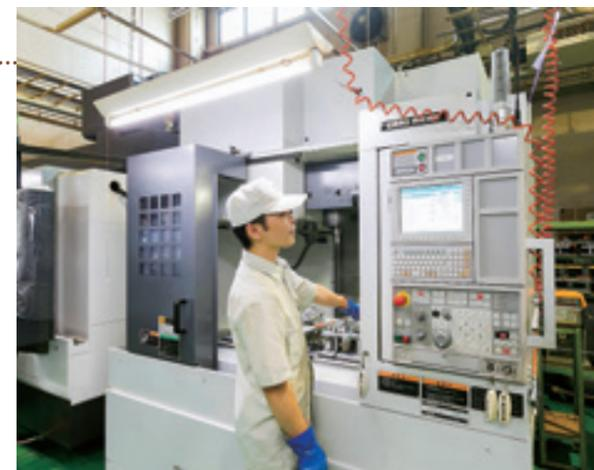
本事業により導入した高精度マシニングセンタ。産業用ロボット部品加工に求められる高い精度と短納期化に対応。
