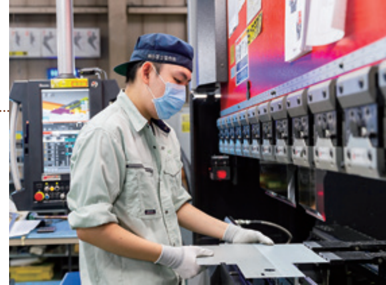
設定した角度に曲げ、誤差も生まれにくい高性能ベンディングマシン。
