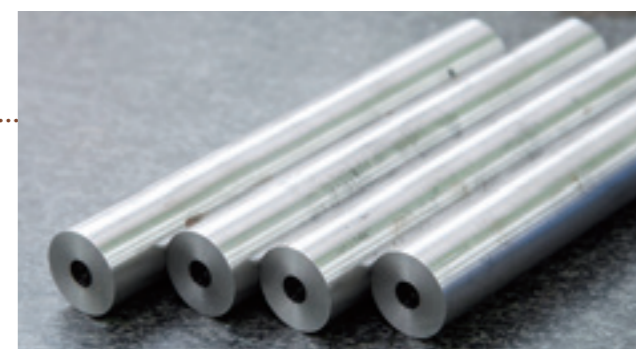
一度に最長500mm、直径3~24mmの穴をあけることができる。また、あけた穴をガイドに直径をさらに広げることも可能となった。
