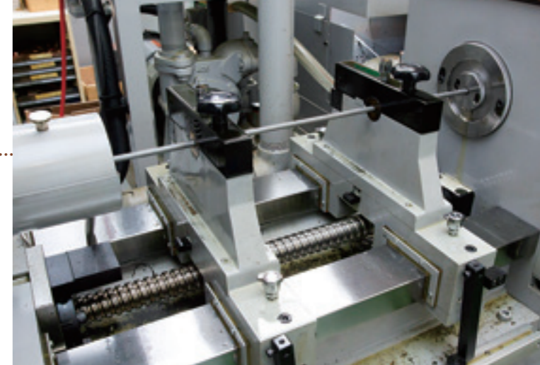
ドリルの先端から高圧で切削油を噴射しながら、ドリルを回転させ穴をあけていく。
