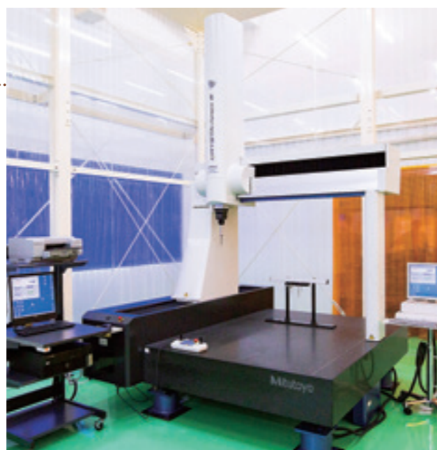
本事業で導入した三次元測定機。自動車部品等の大物部品や曲面形状部品の高精度の測定、測定データの作成ができる。
