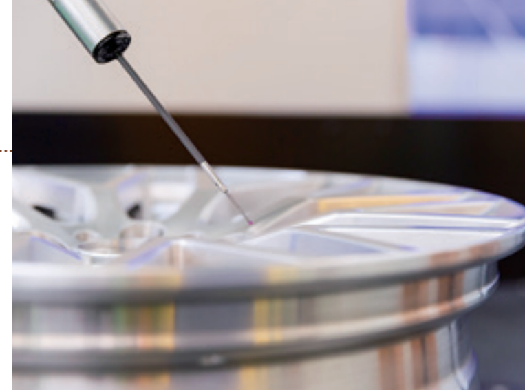
対象物にプローブを接触させて、測定データを読み取る。複雑な立体形状物でも高精度に測定。
