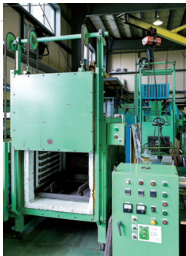
焼き戻しに使用される電気炉。新規設備には改良を加え、3面ヒーター構造に改良し、炉内の温度ムラを軽減。
