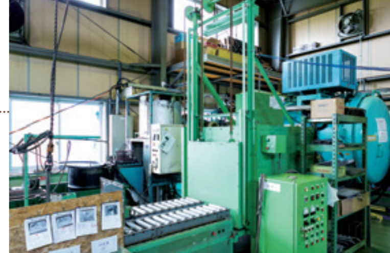
自動開閉扉と自動取り出し装置を付加し、無人の時間帯にも製品の取り出しと炉内の冷却が可能となった。
