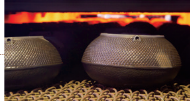
徐々に温度が上がる炉を通過し焼成、冷却まで連続で行うため大幅な時間短縮が可能となった。
