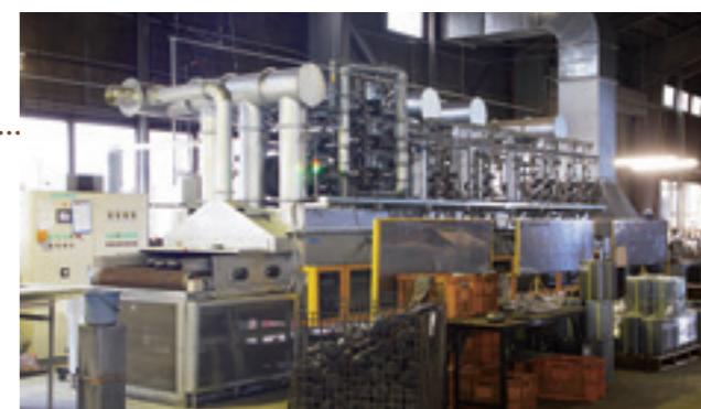
焼成から冷却まで連続で行う「コンベア式連続ホーロー焼成炉」。
