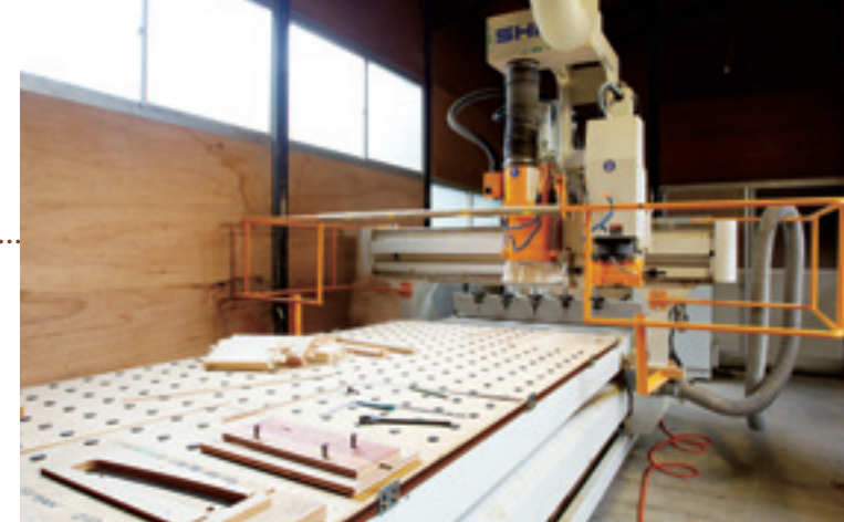
本事業により導入した「NCルーターマシン」。切り抜き加工や立体造形を自動で行う。
