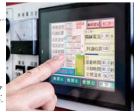
操作は手元のタッチパネルに集約され、加工条件をデジタル表示により管理。
