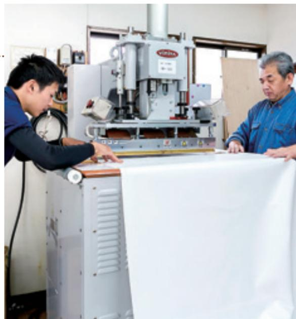
シート生地を溶着し巾縫する加工は、大型シート加工に必須の作業工程。
