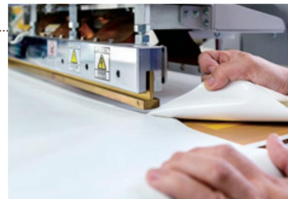
金型の上げ下げが手元のスイッチにより微調整できることから、美しい仕上がりとなる。
