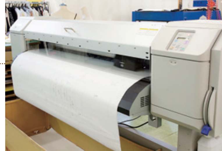
パソコンと連動したインクジェットマーカーから、印字されたパターンを出力。
