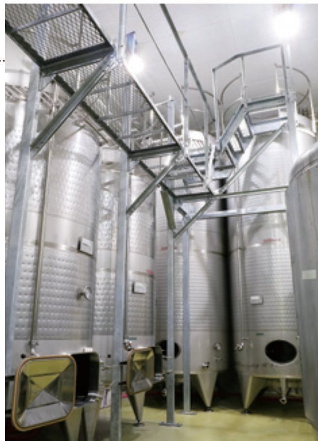
奥にある2本のタンクが10,000ℓ用。敷地面積との兼ね合いもあり、上部にタンクを伸ばすことで容量を増やした。
