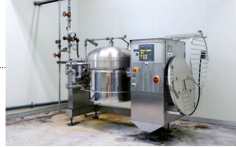
本事業により導入した蒸気加熱攪拌機「レオニーダー」。
