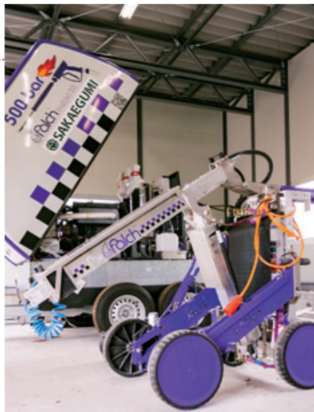
水圧でコンクリート劣化部を除去する「トレーラーウォータージェット」。水の高圧噴射によりピンポイントで劣化部を除去する。
