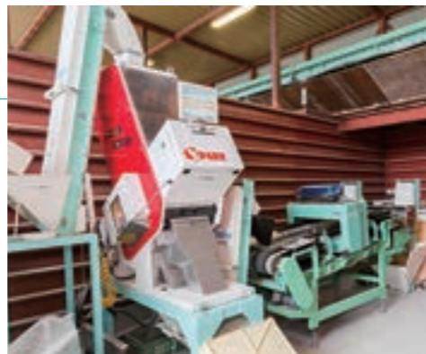
本事業により新たに開発したガラス精製システム。
