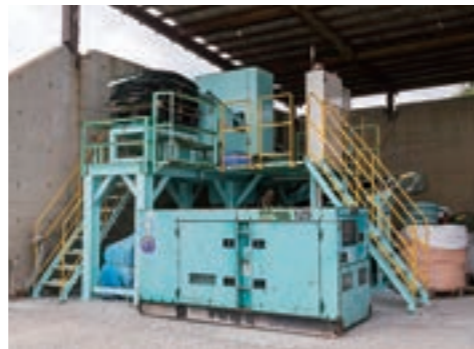
剥離分離器「ガラスわけーるII型」。
