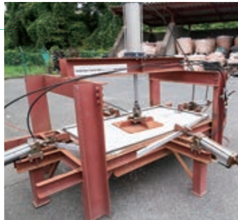
当社開発のアルミ枠解体機。
