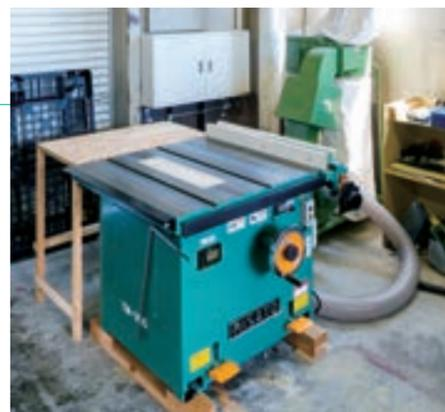
看板等の土台となる、蓄光吹き付け塗装板をカットする軸昇降丸鋸盤。
