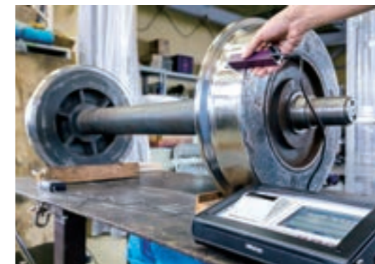
車輪にはフランジがあり、微妙な曲線の加工には高度な技術が求められる。
