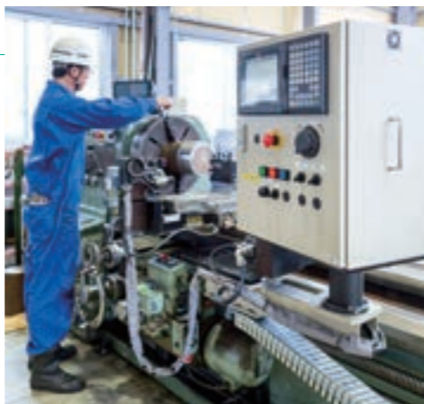
既存の大型汎用旋盤に、NC装置（写真右側）を設置。コンピュータによる切削の自動化が実現。
