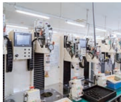
本事業により導入した複合機械。これまで別々の機械で行っていた3工程を1台(ライン)で完了することができる。
