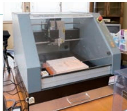
ネジなどの細かいパーツの金型などを切削する3Dプロッタ。
