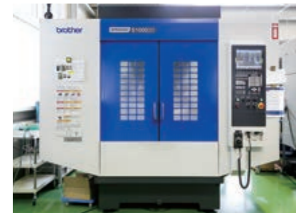
1回のセットですべての加工が可能となるため、段取りに必要な時間や人員が削減できた。また、加工治具の付け替えによる「ずれ」もなくなり、加工精度が向上した。
