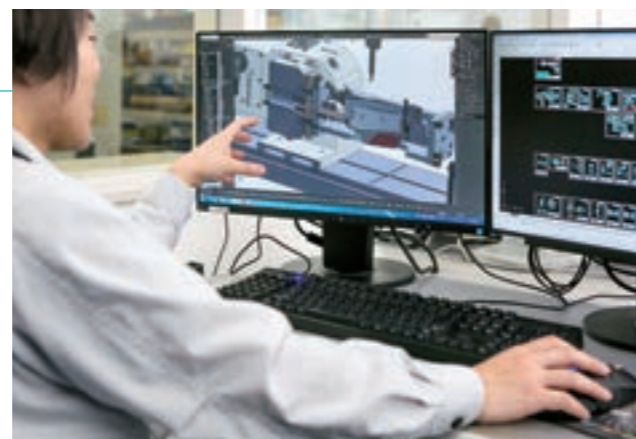
マシニングセンタの導入と合わせ、3次元CADによるオリジナル治具の設計、製作も行った。
