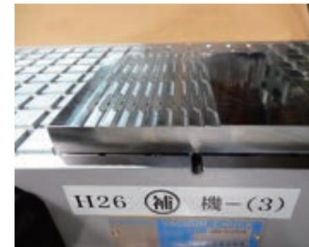
複数枚の刃先研磨を同時に行う、角度成形用治具を開発（エアチャックの上部分）。
